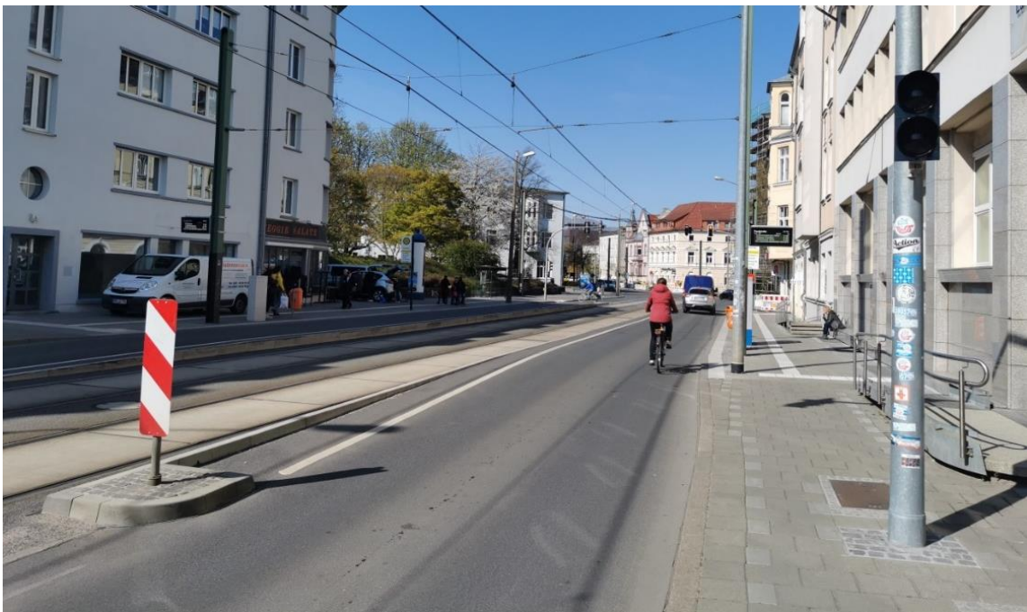
Abbildung 82: Überfahrbares Haltestellenkap im Straßenbahnnetz (Beispiel: Rostock; Haltestelle Paulstraße)
