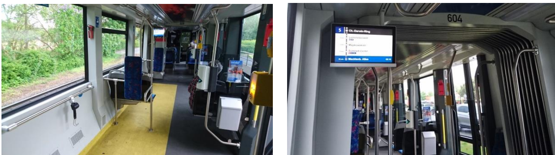
Abbildung 46: Niederflurstraßenbahnen Typ 6N2 (Fahrzeuge entsprechen dem „Stand der Technik“ mit vier Multifunktionsbereichen, Videoüberwachungsanlagen, Haltestellenanzeige sowie Flachbildmonitoren mit Streckenverlaufsanzeige)
