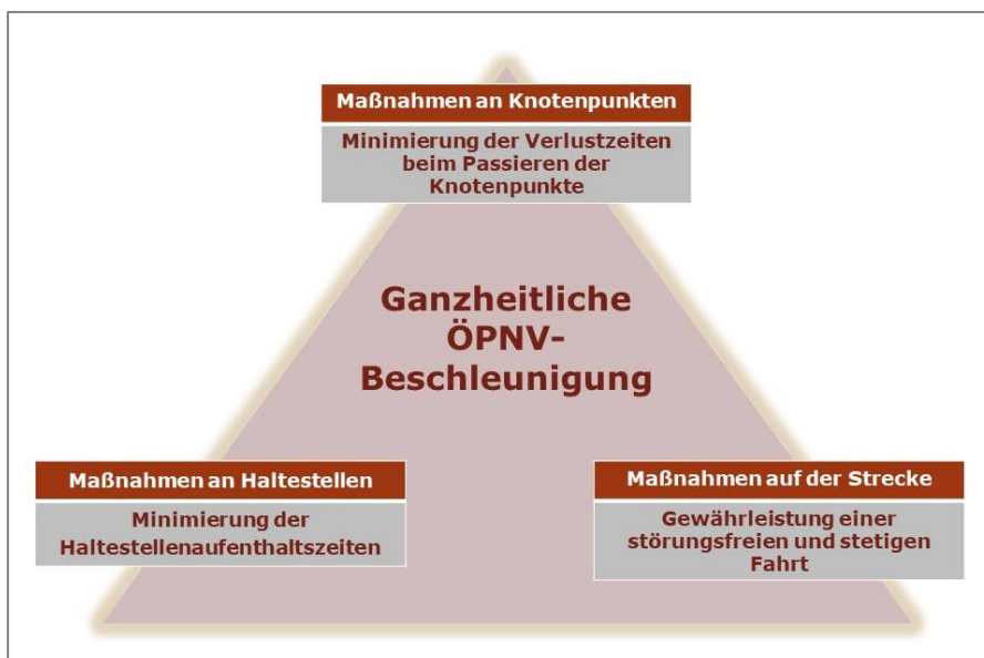
Abbildung 80: Bausteine einer ganzheitlichen ÖPNV-Beschleunigung
