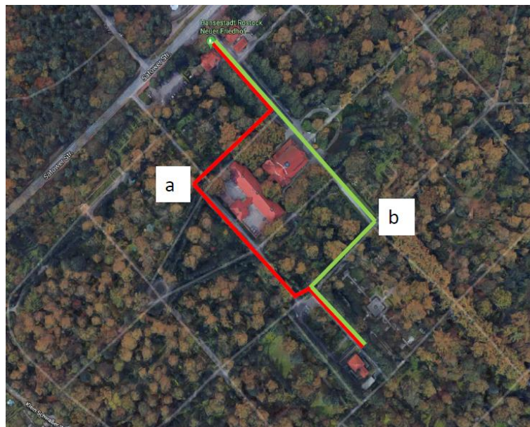
Abbildung 9: mögliche Trassenführung Nahwärmenetz
