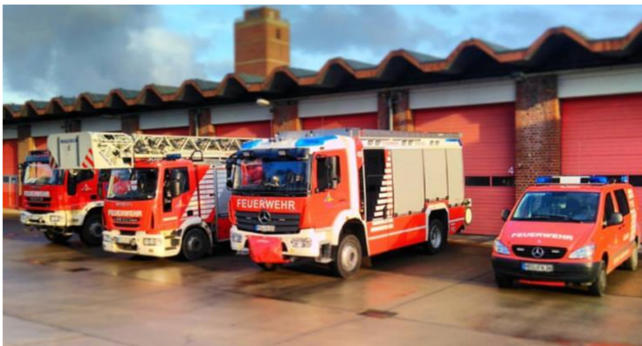
Abbildung 5: Standardlöschzug der Berufsfeuerwehr mit (v.r.n.l.) Einsatzleitwagen ELW 1, Hilfeleistungs-Löschgruppenfahrzeug HLF 20, Drehleiter DLAK 23/12 & Tanklöschfahrzeug TLF (Hanse- und Universitätsstadt Rostock, Brandschutz- und Rettungsamt)
