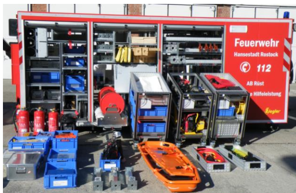
Abbildung 9: Abrollbehälter AB für schwere technische Hilfeleistungseinsätze (Hanse- und Universitätsstadt Rostock, Brandschutz- und Rettungsamt)
