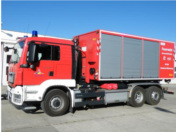
Abbildung 8: Wechselladerfahrzeug WLF mit Abrollbehälter AB (Hanse- und Universitätsstadt Rostock, Brandschutz- und Rettungsamt)
