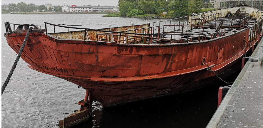
Schiffskörper mit geschlossenem Deck und Konservierung auf Unterkonstruktion, Quelle: Melanie Frödrich
