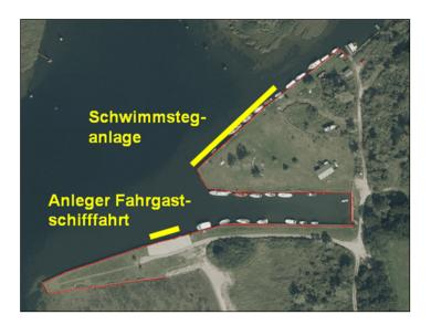
Das **Provisorium 2** zeigt eine Lösung für die Aufrechterhaltung der Fahrgastschifffahrt. Hier wird ein vorhandener ehemaliger Fähranleger der Fährverbindung "Kabutzenhof – Gehlsdorf" wiederverwendet und mit Hilfe von zwei neu zu rammenden Dalben verankert. Ein neu zu schaffender Landgang ermöglicht den Zugang. Die Altanlage wird, wie im Provisorium 1, nicht zurückgebaut und muss weiterhin abgesperrt bleiben.
