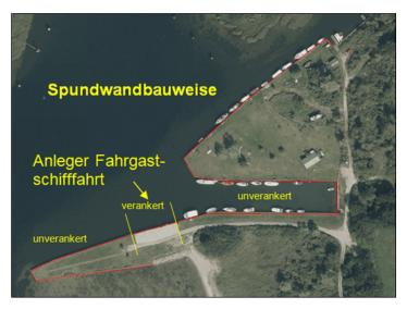
Neubauvariante 2 Spundwandlösung + Steinschüttung - Wiederherstellung des Ist-Zustandes
