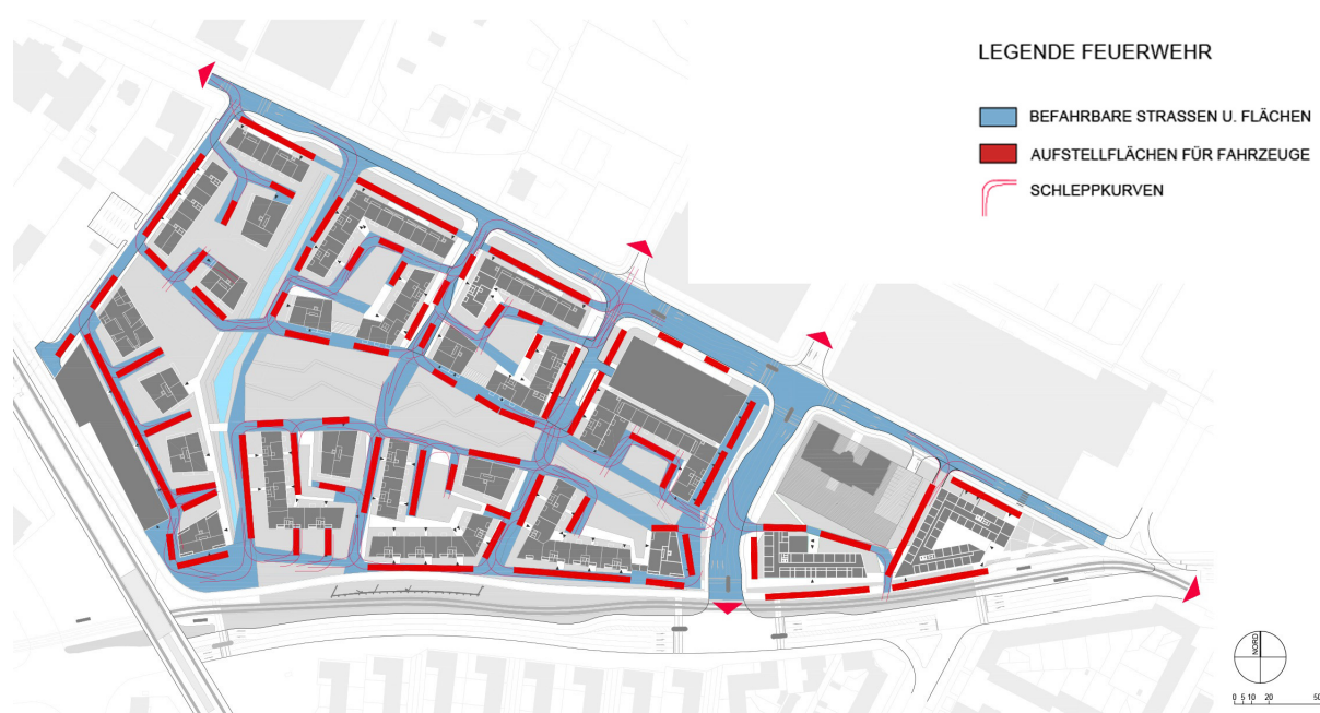
Abbildung 15: Auszug Funktionsplanung (06/2017) "Befahrung Feuerwehr" (nur beispielhafte Darstellung!)
