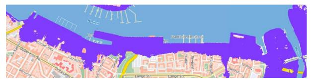
Abbildung XX: Hochwassersituation bei einem Wasserstand von 3,00m über NMW (Geoportal HRO)
