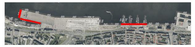
Abb. XX: Schiffsliegeplätze mit möglichen Absenkungsbereichen der Kaikanten
